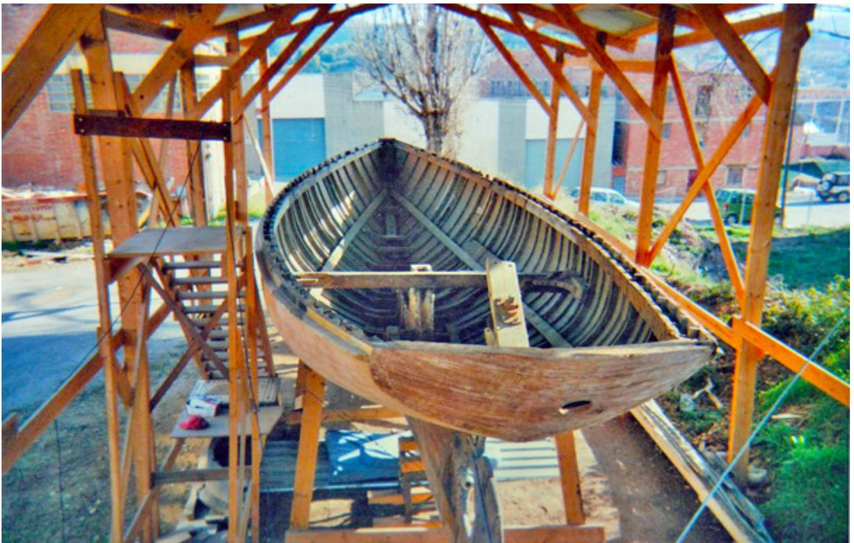
Mientras mis tíos construían la cubierta que protege al barco de las inclemencias del tiempo, comencé a desmontarlo. Menos el alma - por así decirlo (el casco), como se puede apreciar en las fotografías, lo quité todo. Si la restauración debe ser completa,
